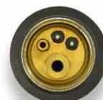
**Conexión central WZ-2F (Euro-conexión central)** adecuada para la mayoría de las máquinas del mercado
